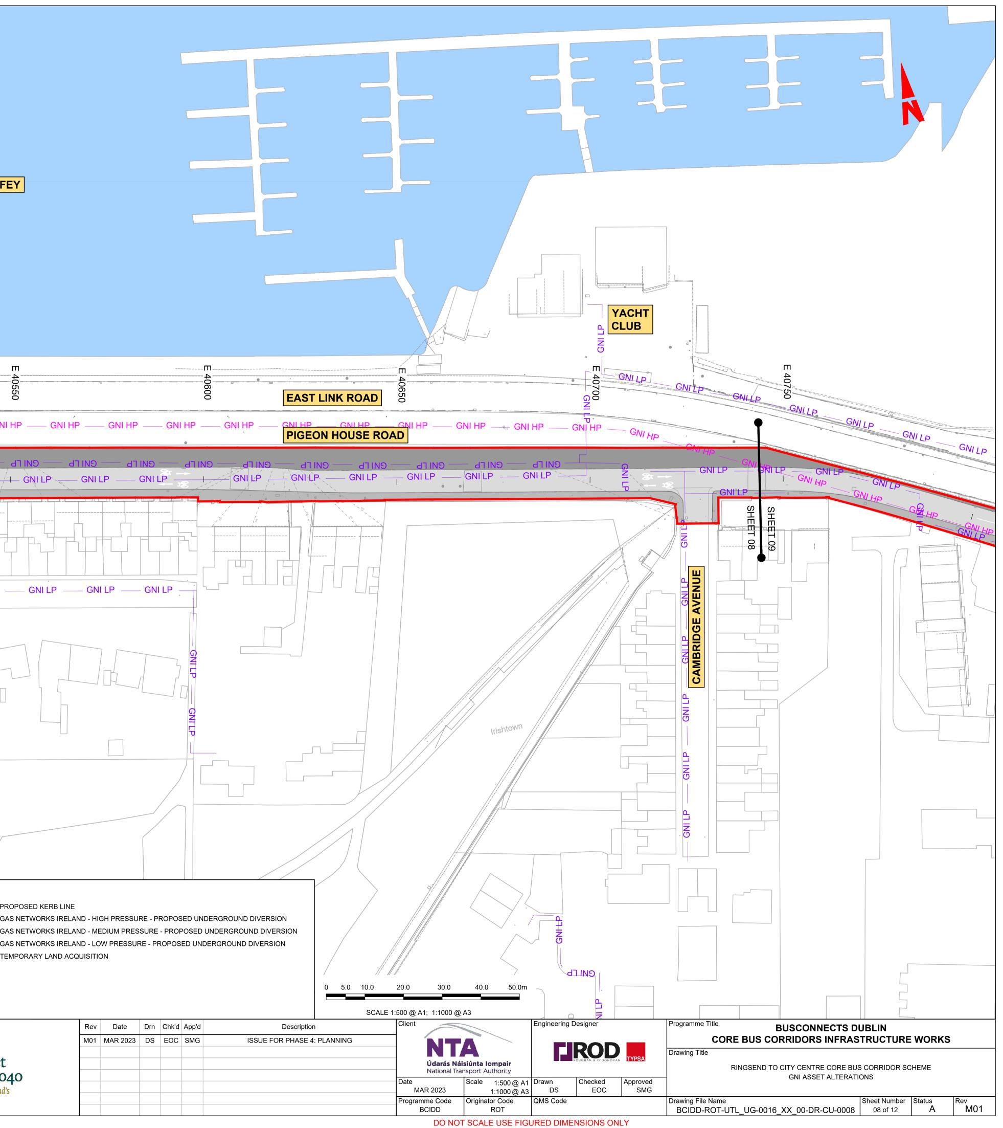
GAS NETWORKS IRELAND - HIGH PRESSURE - PROPOSED UNDERGROUND DIVERSION GAS NETWORKS IRELAND - MEDIUM PRESSURE - PROPOSED UNDERGROUND DIVERSION GAS NETWORKS IRELAND - LOW PRESSURE - PROPOSED UNDERGROUND DIVERSION
